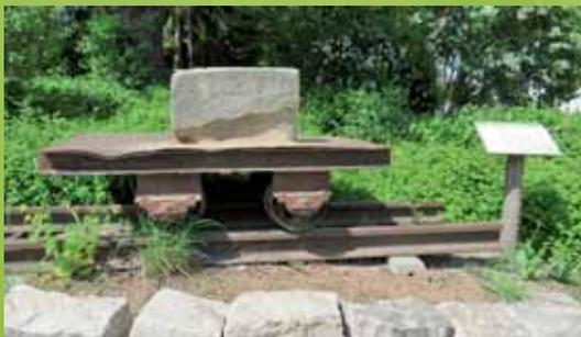
Diese **Lore** ist das letzte schienegebundene Fahrzeug, das im Steinbruch „Wernloch“ eingesetzt war. Sie diente dem Transport von Sandsteinquadern.
