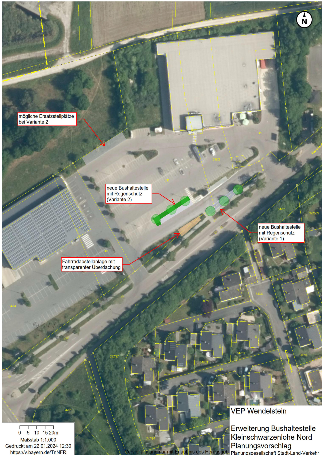
Abbildung 113: Prinzipskizze Erweiterung der Bushaltestelle „Kleinschwarzenlohe Nord“ im Zuge der Verknüpfung mit weiteren Linien
